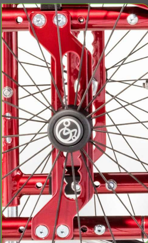
Placa de eixo regulável para ajuste de centro de gravidade mais ativo staggered wheel plate for active adjustment.
