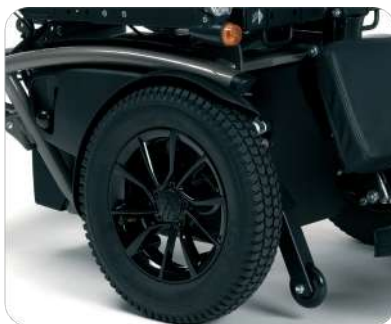
Rodas dianteiras grandes, com pneus de cravos, para maior aderência em superfícies externas
