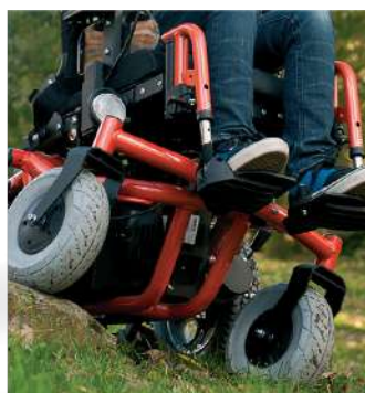
Seu eixo pivotante dianteiro permite o contato das rodas com o solo em todos os momentos, mesmo em grandes desníveis
