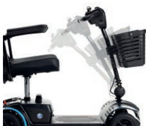
Columna de dirección ajustable
