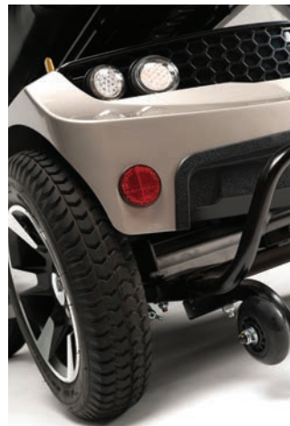
Anti-vuelcos, luces frontales y traseras y reflectores adicionales
