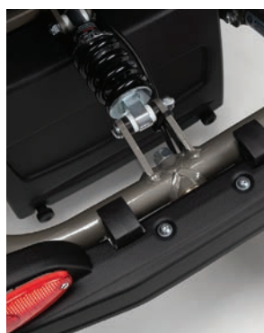
Eje giratorio para permitir un contacto constante con el suelo.
