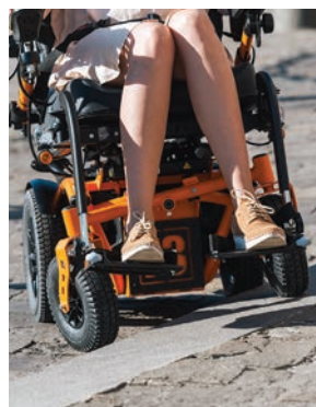
Eje pivotante delantero para superar obstáculos manteniendo las 4 ruedas en el suelo
