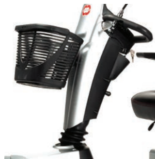
Columna de dirección regulable en ángulo
