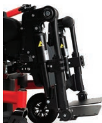
BZ8E ART Reposapiés elevables eléctricos
