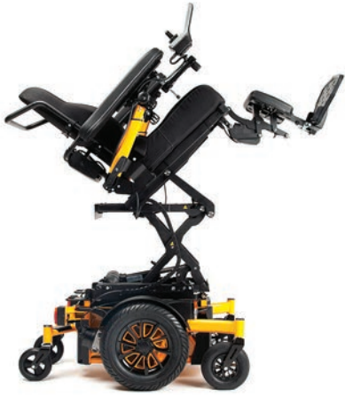
SE42+SE39 - LIFT opcional con inclinación del asiento de 45°
