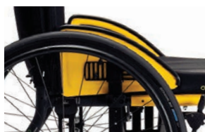
B82SL-A Protector de ropa de aluminio largo y extraíble
