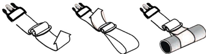
Los extremos del cinturón **3** deben montarse en la silla como se indica en la imagen.
