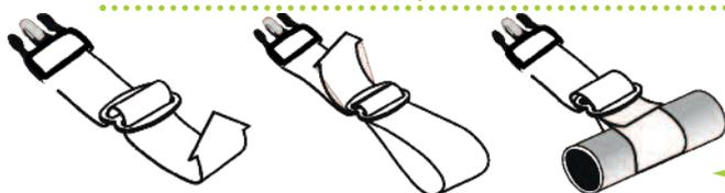
Los extremos del cinturón **3** deben montarse en la silla como se indica en la imagen.
